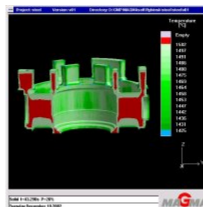
Рис. 3. Образование дефектов, связанных с усадкой
